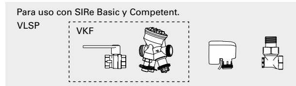
VLSP, sistema de válvulas independientes de la presión on/off
