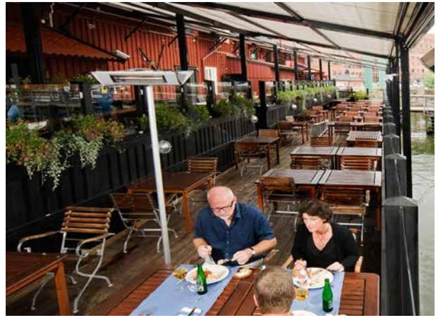
Montanti per il montaggio a pavimento sono disponibili come optional. Con una staffa tripla, è possibile posizionare tre riscaldatori a infrarossi sullo stesso montante, in modo da indirizzare il calore in tutte le direzioni.
