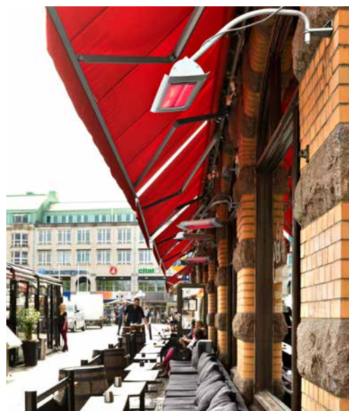
Mit einer Verlängerungshalterung kann der Strahler unter seinem Befestigungspunkt angebracht werden.
