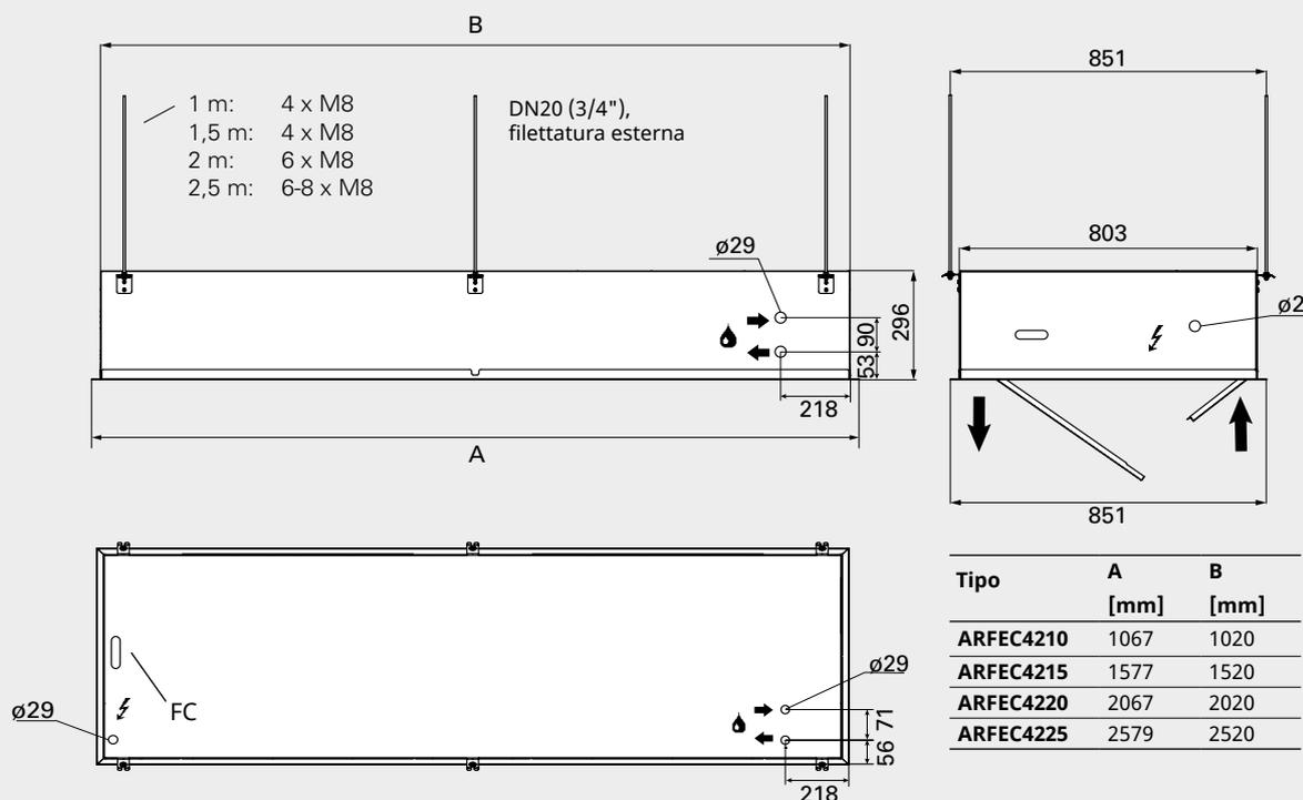
Per le unità con riscaldamento elettrico, la distanza minima fra l'apertura di mandata e il pavimento è pari a 1800 mm.
