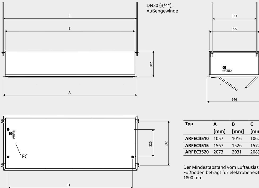
Der Mindestabstand vom Luftauslass zum Fußboden beträgt für elektroheizte Geräte 1800 mm.
