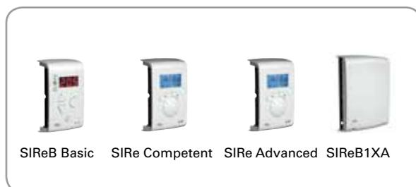
Questa lama d'aria è regolata dal sistema di controllo SIRE mediante una scheda PC esterna. È possibile scegliere fra tre livelli diversi, vale a dire Basic, Competent o Advanced, con funzioni differenti. Un comando SIRE può controllare fino a nove lame d'aria AR200. Ciascun modello AR200 richiede una scheda PC esterna SIREB1XA.
